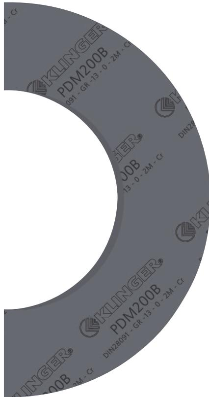
**Kleberfreies Dichtungsmaterial aus expandiertem Graphit mit zwei perforierten 0,1 mm dicken Spießblecheinlage aus Edelstahl 1.4401.**
